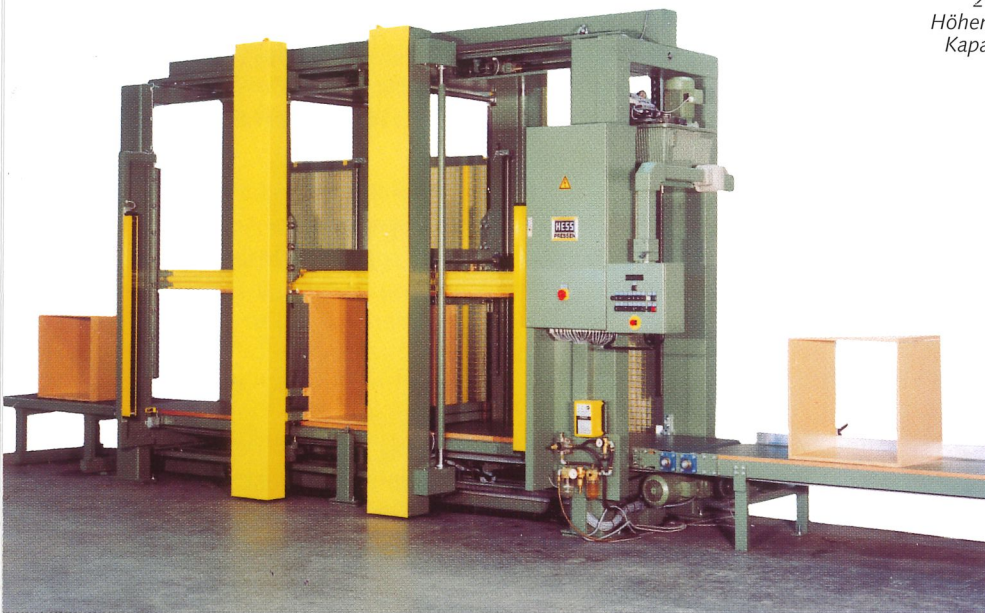
Hess-Formatic-linear-Durchlaufkorpus- presse mit automatischem Pressablauf und Durchtransport. Maßerkennung über Opto-Elektronik. Schwere Bauweise.
