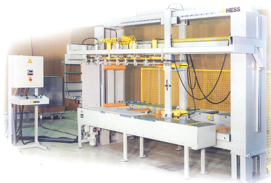
Hess-Korpuslinie „Express“ in Sonderausführung bestehend aus: • Vormontagestation • Vormontagehilfe • Korpuspresse mit integriertem Quertransport über 2 Bandförderer • Übernahmestation • Aufrichtstation • Drehstation • Hubstation
