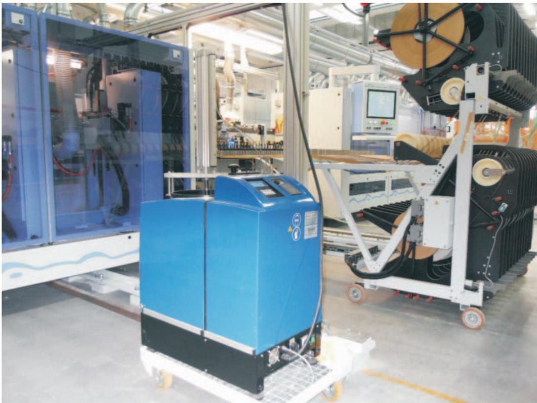
Das Gerät wird auf einem Wagen montiert und bewegt sich entsprechend der Breitenverstellung der Kantenanleimmaschine.
