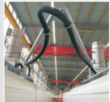
Schlauchverlegung bei der Breitenverstellung der Maschine
