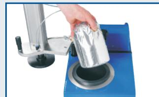
Einfacher Beutelwechsel mit kontinuierlicher Gerätefunktion.
