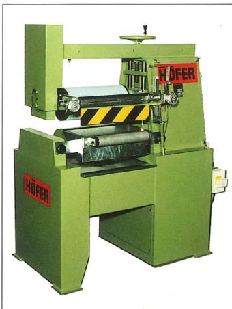
LAe 700 – einseitig offene Ausführung. Maximale Arbeitsbreite bei zweimaligem Durchlauf 1400 mm. Technische Daten wie LAn.
