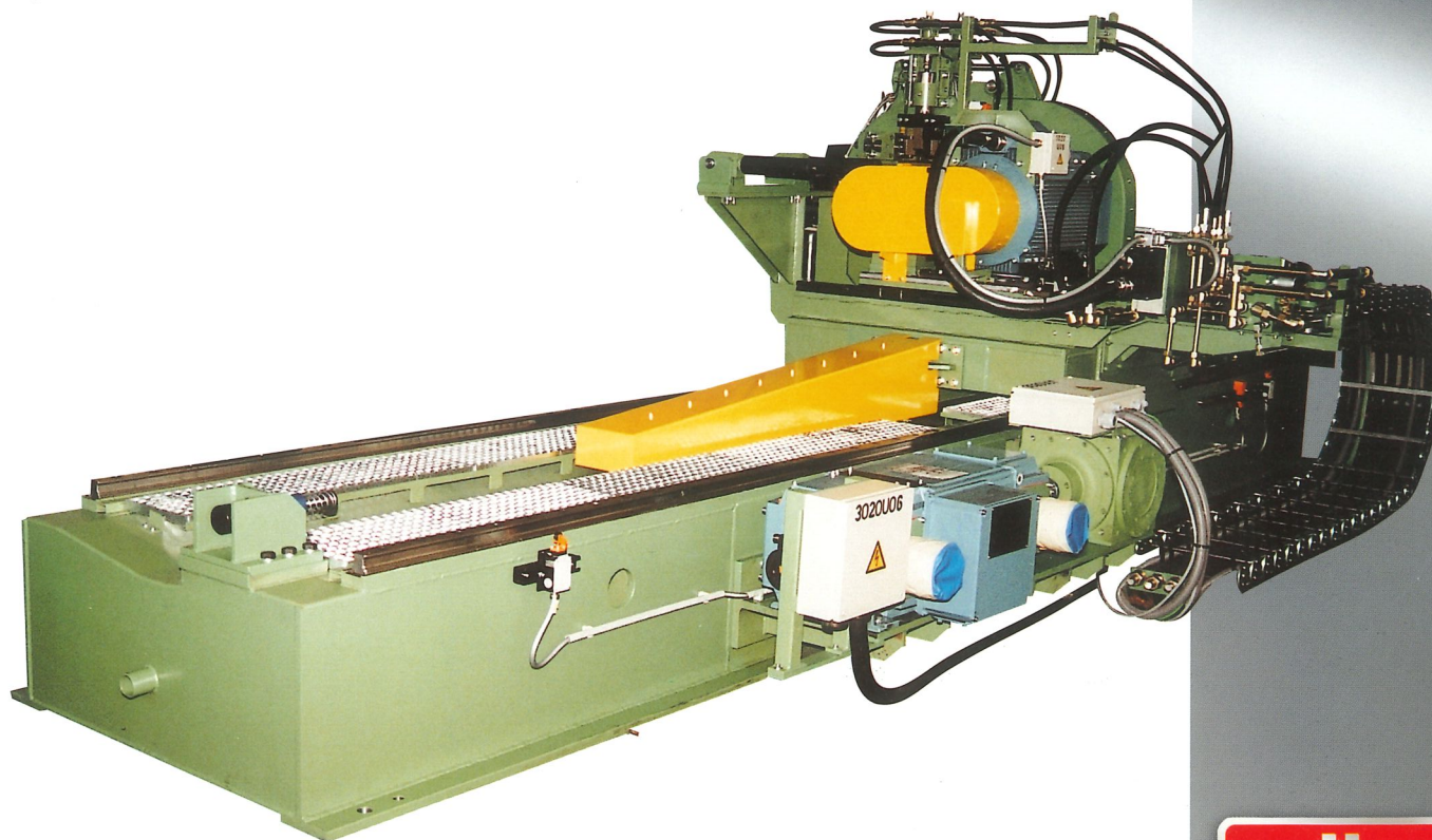
Kaltsäge - Sägeblatt \varnothing 800 mm
