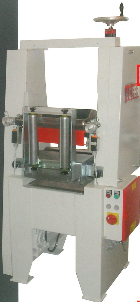
Bürst-Entstaubungsmaschine mit Leimauftragmaschine
