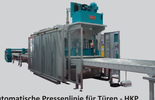
Semiautomatische Pressenlinie für Türen - HKP Semi-automated press line for doors - HKP
