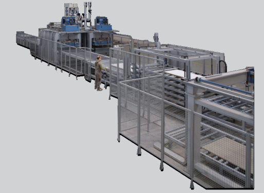
Vollautomatische Türenproduktionsanlage - HKP Full-automated door-production line - HKP
