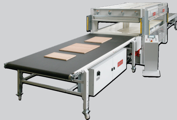
Furnierpresse mit Beschickungshilfe - EXPERT DL Veneer press with loading assistance - EXPERT DL
