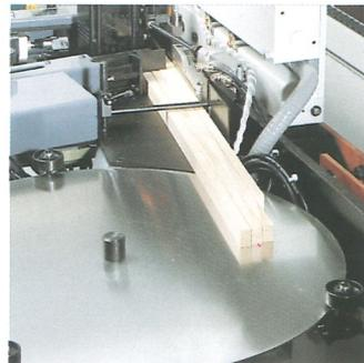
Zu den Fräsaggregaten, die die Längskante bearbeiten, braucht nur 1 Fräsmotor eingestellt zu werden. Kompakt, sicher und einfach.
