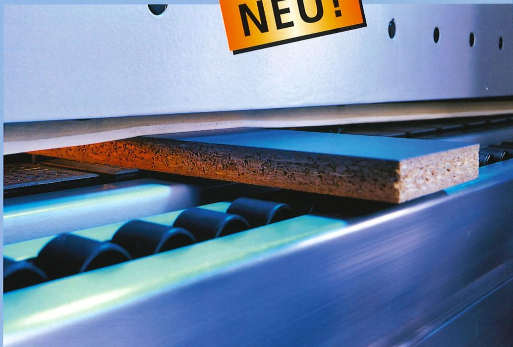
Riemenbrücke für Kantenanleimmaschinen
