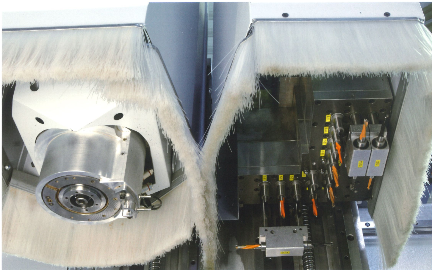
Hauptspindel und Bohrkopf mit separaten Z-Achsen zum Werkzeugwechsel der Hauptspindel während des Einsatzes des Bohrkopfs (Option Performance Pack)
