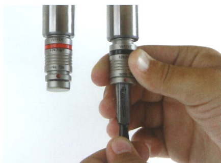
Das patentierte Schnellwechselsystem des Bohrkopfes ermöglicht ein Austauschen der Bohrer ohne Werkzeuge
