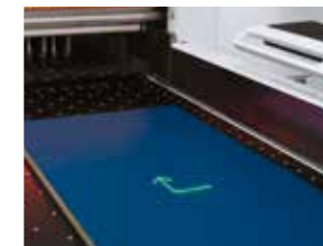
Rotationspfeile auf einem Werkstück zeigen die erforderliche Drehrichtung an – so lange, bis die Ausrichtung stimmt.
