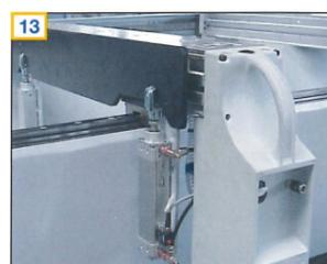
13 Robuste Einlegehilfen zur Auflage schwerer Werkstücke
