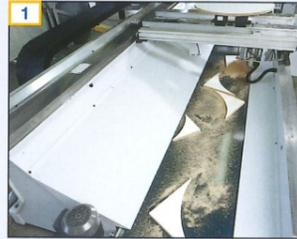
1 Arbeitsfeld von X = 3.175 mm (22), 4.175 mm (22L) bzw. 6.175 (22XL) und Y = 1.730 mm mit optimaler Reststückentsorgung durch das „offene“ Maschinenbett (optional mit Spänetransportband)
