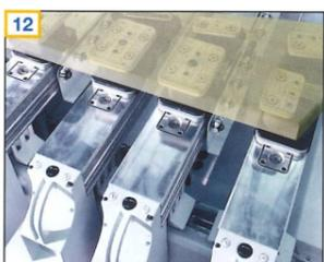
12 Arbeitstisch mit 6, 8 bzw. 10 Konsolen und präzisen Linearführungen zur optimalen Werkstückspannung bei schwerer Zerspanung
