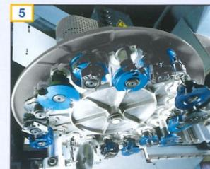
5 Schneller Tellerwechsler mit 18 großen Plätzen für Werkzeuge und Aggregate mit einem Durchmesser von bis zu 180 mm
