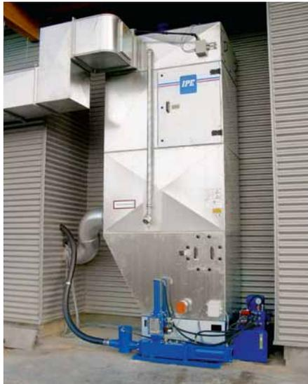
BG-JET-Anlagen sind auch mit untergebauter Brikettpresse für die Außenaufstellung geeignet. Hierzu sind entsprechende Wetterschutzeinrichtungen (Wetterschutzschrank für die Brikettpresse und Wetterschutzdach für die Filteranlage) verfügbar.
