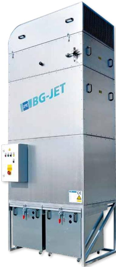
Reinluft-Unterdrucksystem mit eingebautem Hochleistungsventilator, wahlweise von 1.550 bis 2.950 Pa Unterdruck, Schaltschrank mit Volumenstromüberwachung und automatischer JET-Impuls-Abreinigung, Erkennung von 4 Bearbeitungsmaschinen mit autom. Ventilatoranlauf, 5 m Anschlusskabel mit CEE-Stecker, 5-polig, 32 A, Phasenwender.
