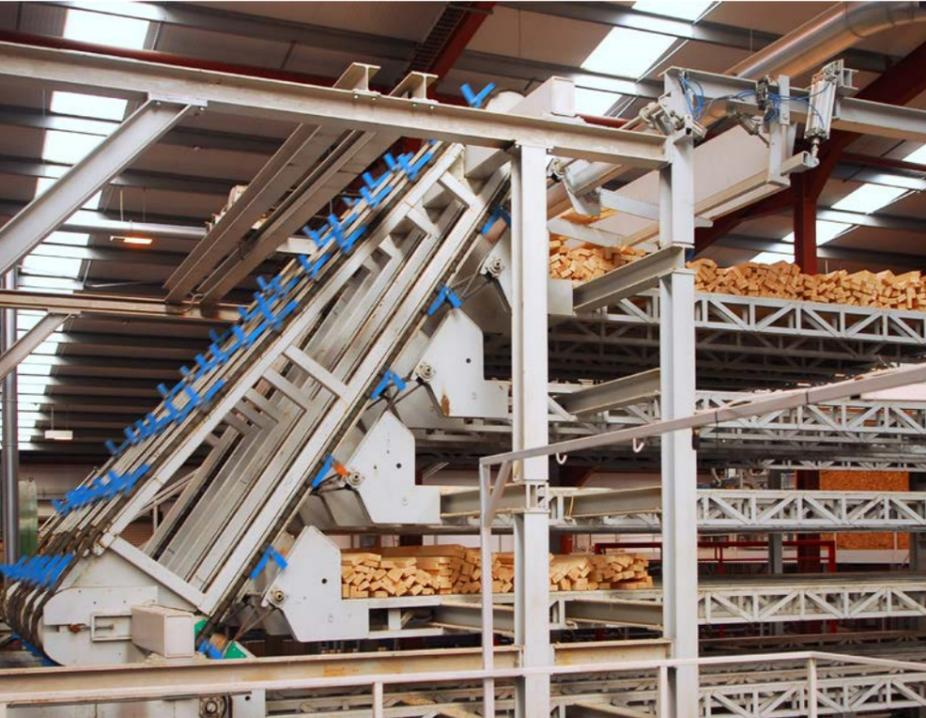
**Pufferetagensortierungen** sortieren Chargenware lose übereinanderliegend in Etagen ein. Die Ware muss vor dem Befüllen und nach dem Entleeren vereinzelt werden.
