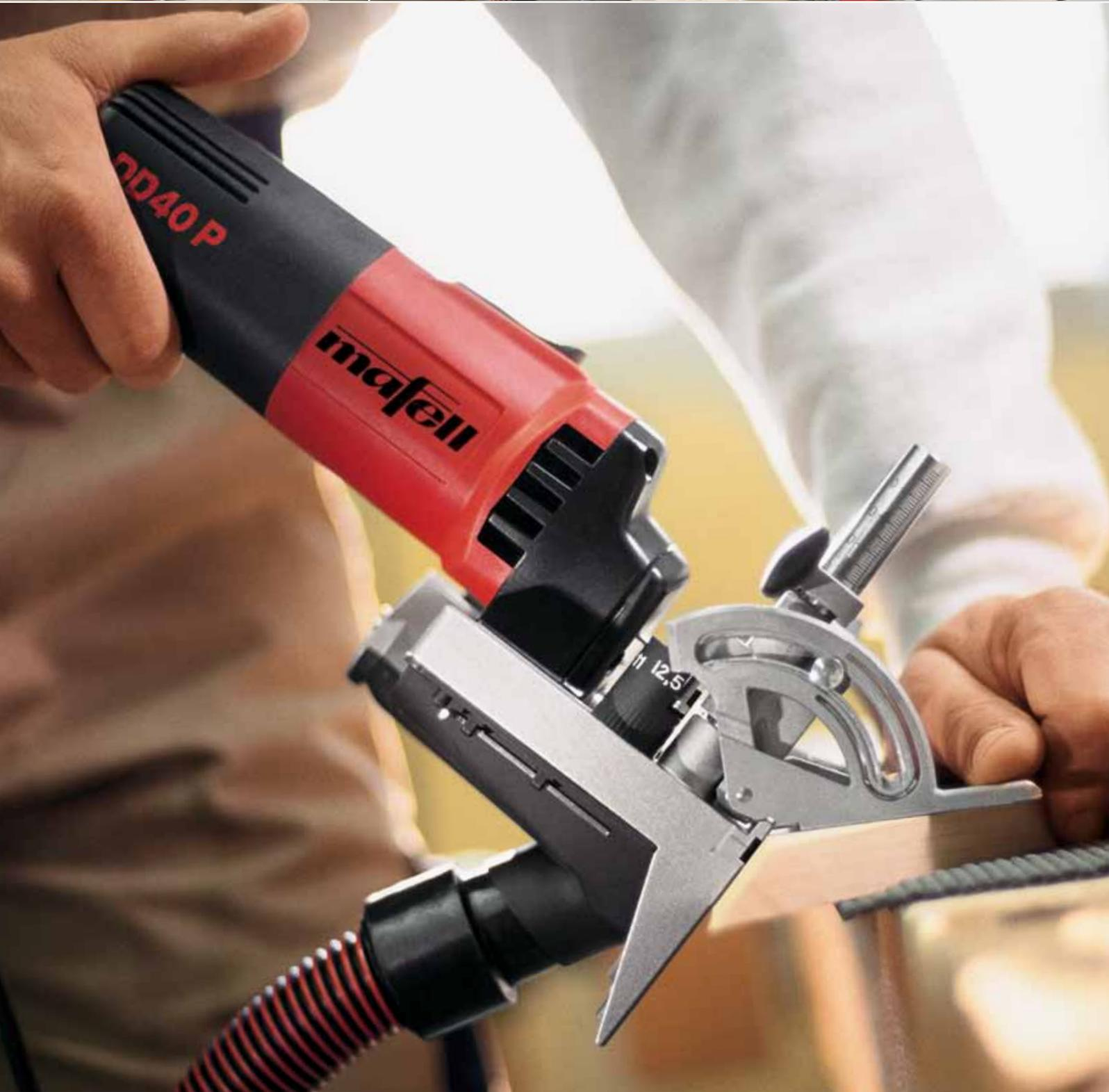
Mit dem DD40 kann auch ohne Anschlag und Dübel-Lehre über Anrisslinien mitten auf dem Werkstück gebohrt werden.
