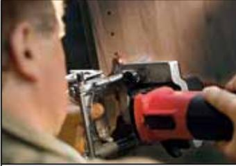
Mit den Zusatzanschlügen lassen sich auch an bereits aufgestellten Möbeln schnell und präzise Lochreihen bohren.
