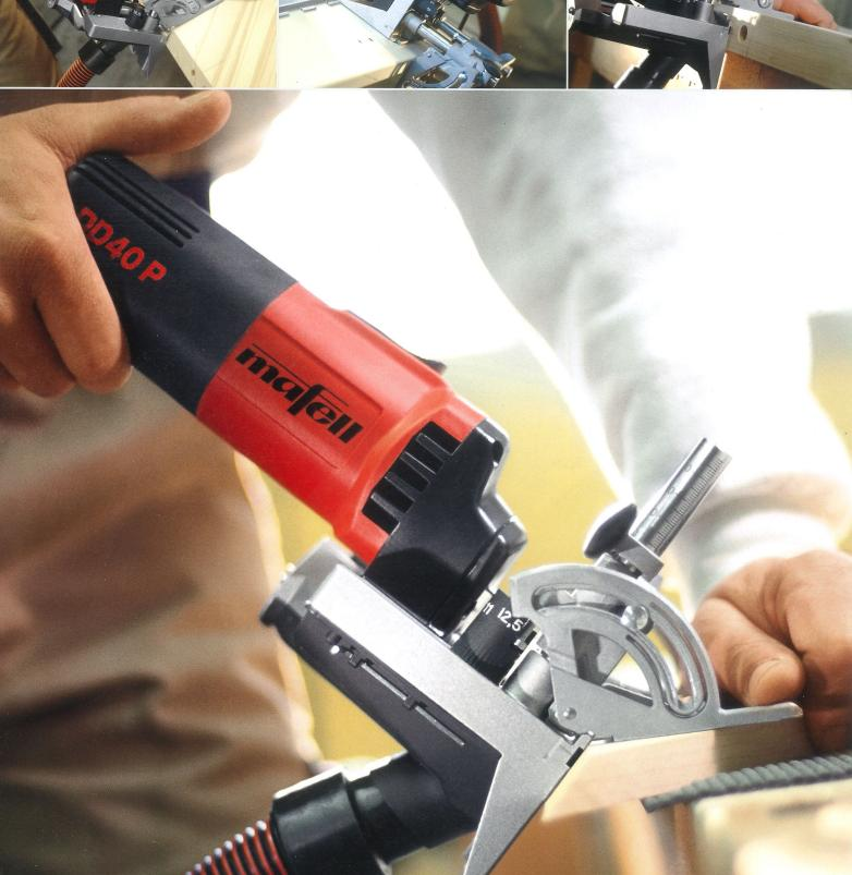
Mit den Zusatzanschlägen lassen sich auch kleine Werkstücke schnell und präzise bearbeiten
