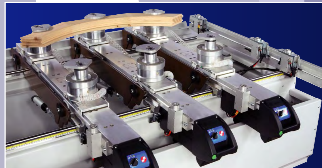
Profilatura interna dell'arco. Profilage intérieur du cintre. Profilieren der Bogen-Innenseite.
