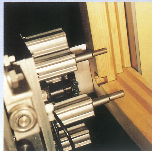
Abb.: Topfbandbohraggregat mit ausgefahrenen Positionier-Anschlägen für maßgenaues Bohren.
