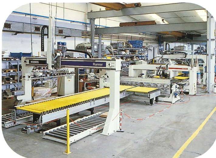
Author 660 fms asservita da impianto di carico e scarico automatico
