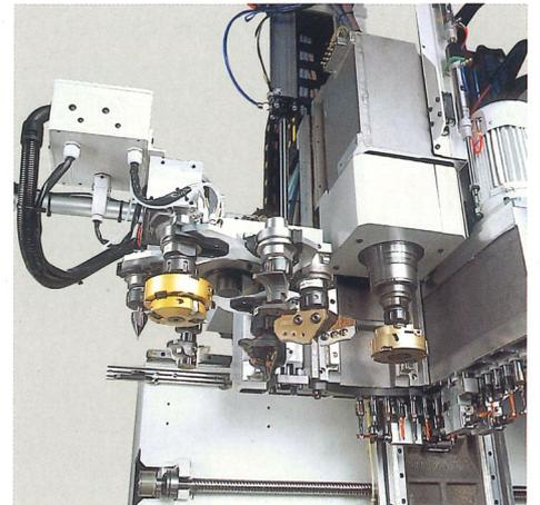
Der Vorteil **einer zweiten Fräseinheit mit 7,5/11 kW**, die die Werkzeuge aus einem eigenen **RAPID-Magazin mit 6 Plätzen** einwechseln kann, während die Haupteinheit andere Bearbeitungen ausführt, führt zu einer beträchtlichen Reduzierung der Stillstand- bzw. Rüstzeiten sowie zu einer noch **schnelleren Amortisation**.
