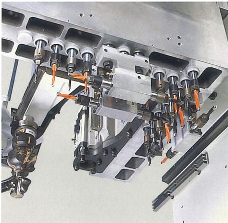
Die leistungsstarke Bohreinheit mit 18 oder 30 Vertikalspindeln und 8 Horizontalspindeln **stellt auch die anspruchsvollsten Kunden zufrieden**. Der gesamte Bohrbestückung ist **ständig abrufbereit**, sodass unterschiedlichste Werkstücke in ausgesprochen kurzen Zeiten produziert werden können.
