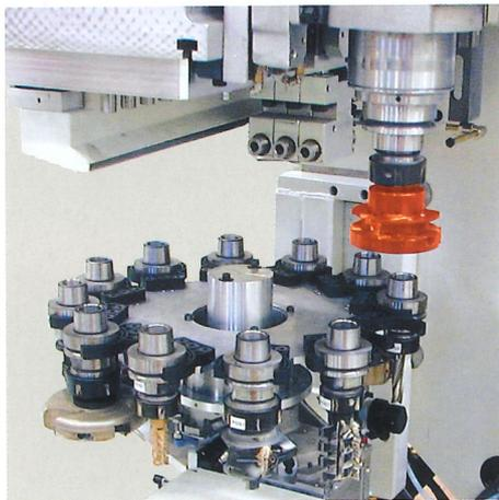
Für all diejenigen, die eine sehr hohe Anzahl an Werkzeugen verwenden, stellt das Tool Room mit 12 Werkzeugen, das direkt auf den beweglichen Ständer auf der X-Achse montiert wird, immer alles Nötige für Bearbeitungen, die unterschiedliche Profile verlangen, zur Verfügung.
