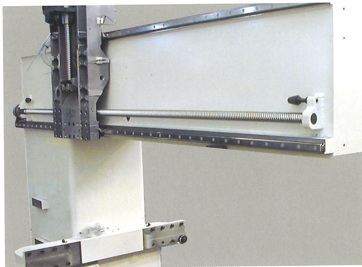
Der Lauf der beweglichen Aggregate erfolgt auf geschliffenen Prismenführungen, die gegenüber ihrer vertikalen Achse verschoben sind, um einen genauen Ausgleich der Belastungen während der Bearbeitung zu gewährleisten.
