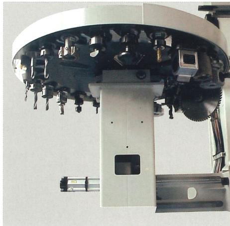
Manuelle Eingriffe zum Auswechseln der Werkzeuge in der Maschine beim Produktionswechsel sind nun endgültig überflüssig dank des neuen **Tool-Room mit 24 Werkzeugplätzen**, die sich für den Einsatz bei komplexen Fräsarbeiten optimal eignet. Zwei Fräsaggregate können die Werkzeuge **automatisch** aus dem gleichen Tool-Room\* entnehmen, wodurch die **Werkzeugwechselzeiten reduziert und optimiert** werden.
