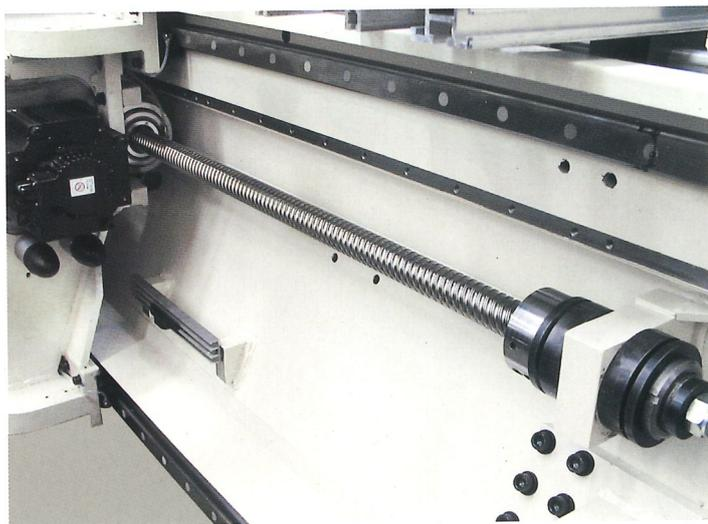
Die Bewegung der Achsen X, Y und Z erfolgt durch bürstenlose Motoren auf Kuglrücklaufschrauben; auf diese Art sind **Beschleunigungen und Abbremsen bis zu 5 m/sec<sup>2</sup>** mit absoluter Präzision bei der Positionierung möglich. Alle bewegliche Teile werden automatisch geschmiert und sind somit wartungsfrei.
