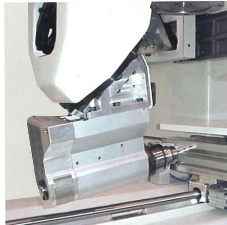
Das Aggregat X5 kann auf der X/Y-Eben um 640° und um 270° im Raum rotieren, um Bohrungen, Schnitte und Fräsungen bis zu 10° unter der rechtwinkligen Ebene des bearbeiteten Werkstücks zu ermöglichen.
