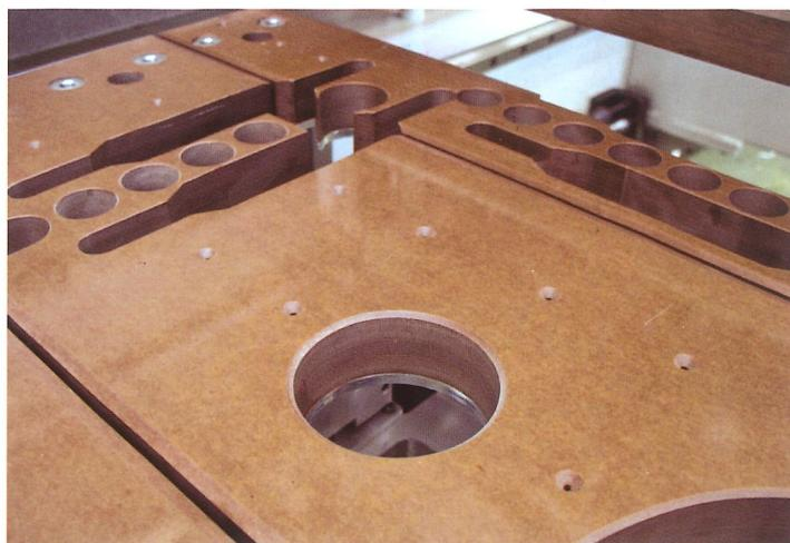
Un sistema a piani di contrasto a velo d'aria che si auto-adattano allo spessore del pezzo in lavorazione, garantisce una lavorazione impeccabile su tutti i tipi di materiale, con tutte le configurazioni possibili della UNIX.
