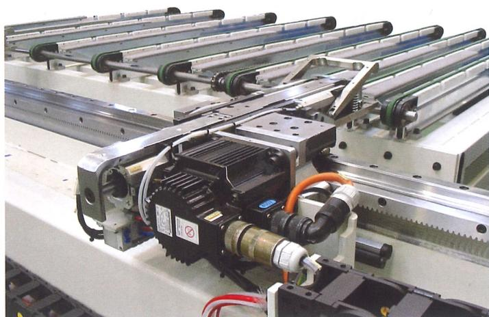
La movimentazione del pannello, lungo l'asse longitudinale della macchina, viene effettuata da una sistema di pinze indipendenti tra loro (patent pending Morbidelli) mosse da motori brushless e governate dal controllo numerico, che fungono anche da battuta di riferimento posteriore per l'allineamento dei pannelli. Una velocità di spostamento di oltre 100m/min conferisce a tutto il sistema una rapidità di posizionamento e di lavorazione senza precedenti.
