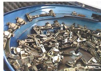
L'approvvigionamento dei singoli gruppi di inserimento può essere gestita sia manualmente sia in modo automatico, tramite degli alimentatori a vibrazione o magazzini esterni, per elevate cadenze produttive.
