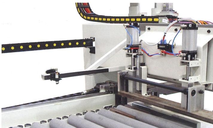
UNIX può essere equipaggiata con sistemi integrati di lettura della lunghezza e dello spessore del pezzo in ingresso, che permettono di acquisire in tempo reale le caratteristiche dimensionali di ogni singolo pannello in ingresso.
