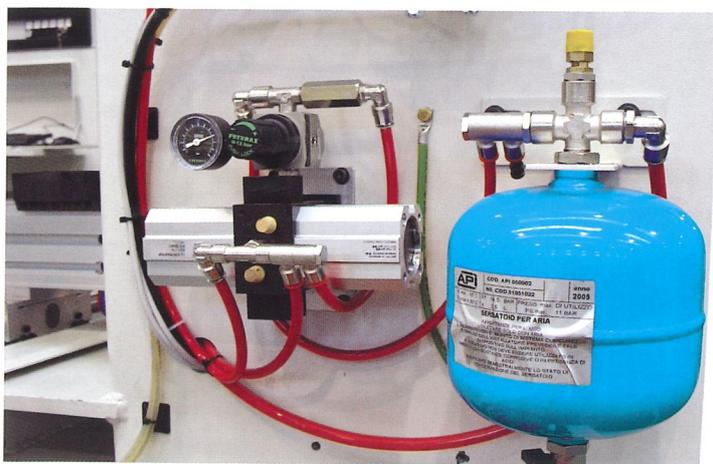
L'attivazione pneumatica di ogni singolo mandrino è garantita da un **sistema di aria compressa auto-moltiplicata a 9 BAR**, per affrontare lavorazioni gravose anche su **materiali particolarmente duri** come il laminato plastico.
