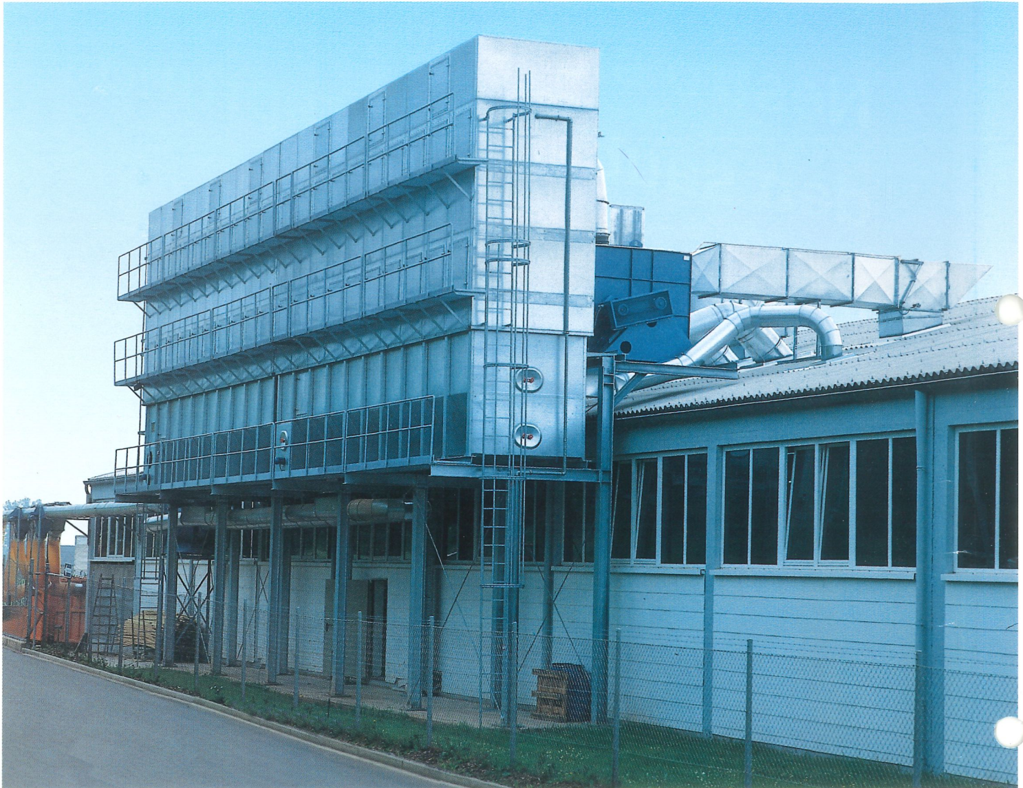
Abb. zeigt: Unterdruckfilter mit 1.200 m 2 , Filterfläche! Für eine Luftmenge von 120.000 m 3 /h bei einem ges. Widerstand von 3.100 Pa. Diese Leistung wird mit 4 Ventilatoren, mit je 1 Elektro-Motor von 37 kW erzielt. Die tatsächliche Leistung pro Ventilator liegt unter 33 kW, die ges. Leistung beträgt somit ca. 132 kW pro Std. Der Wirkungsgrad der Anlage beträgt 80 %.
