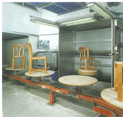
Abb. zeigt Wasserwand mit Reini- gungsanlage in einer Möbelfabrik.
