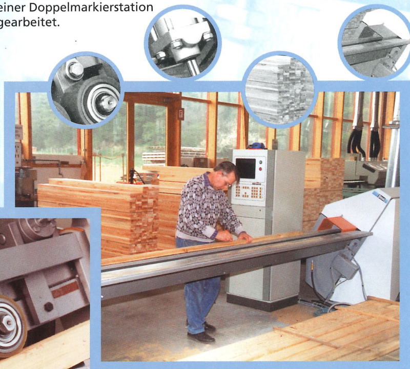
Abb. 8 Fehlermarkierung beim Modell 11 KE
