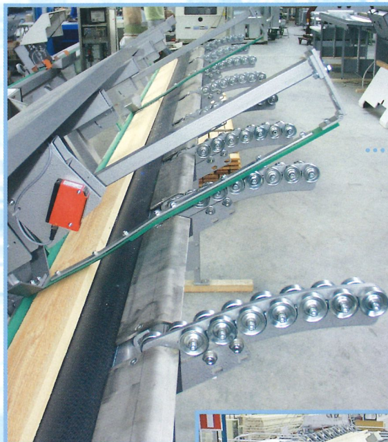
Abb. 11 Puffersystem für den Zutransport
