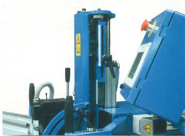
Profondeur automatique sur barillets Automatic depth setting Automatische diepte instelling automatische Tiefeneinstellung über Skala
