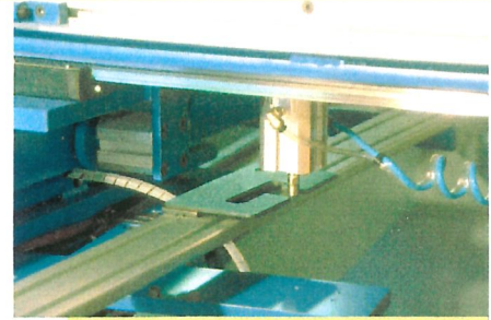
Pneum. Einrastung der Kopiereinrichtung mit Schablon
