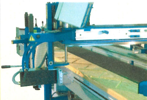
Schwenkbarer Fräsmotor von -5° bis 90° für bohren - nuten usw.
