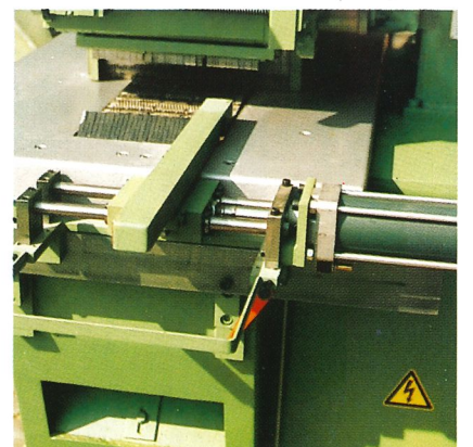
Schnellverstellungsanschlag pneumatisch Pneumatic quick adjustment fence Guide pneumatique pour réglage rapide
