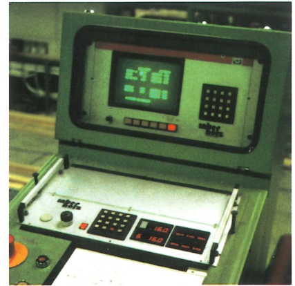
Sägeblattverstellung, elektronisch, mit rechnergestützter Optimierung und Bildschirmanzeige Electronic sawblade adjustment with computer added optimization and screen display Réglage électronique de la lame avec optimisation à commande numérique et écran de visualisation
