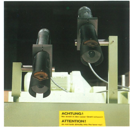
Bewegliches Laser-Richtlicht, synchron mit dem Sägeblatt verstellbar Movable laser guide light running synchronously with saw blade Laser mobile, réglage synchrone avec la lame
