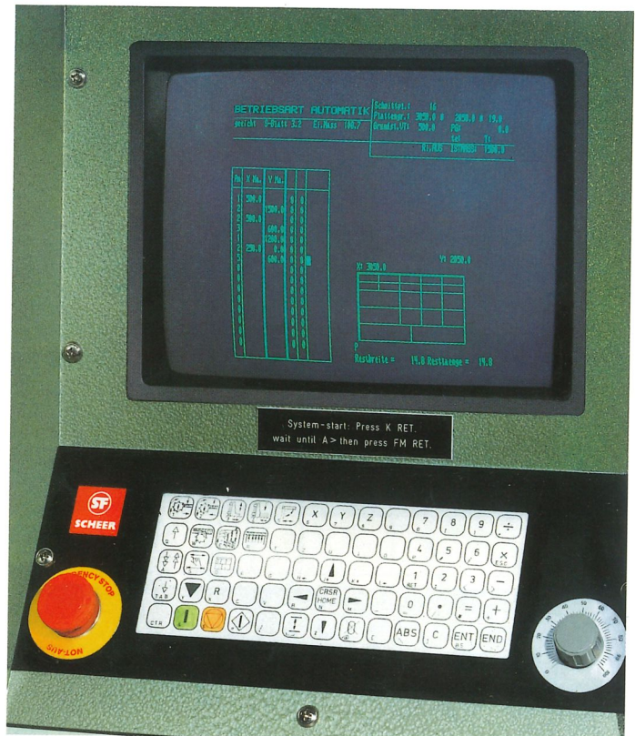
Die DNC-Steuerung bietet durch die Abspeicherung auf Floppy eine nahezu unbegrenzte Speichermöglichkeit von Schnittplänen; außerdem zeigt der Bildschirm neben der Tabelle der eingegebenen Werte auch den errechneten Schnittplan. Eine übersichtliche Eingabetastatur macht die Programmierung und die Maßeingabe nach Stückliste problemlos.
