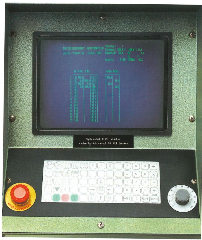
Die NC-Multiprozessor-Steuerung zeigt auf dem Bildschirm eine Tabelle mit den eingegebenen Maßen und Stückzahlen. Die Speicherkapazität beträgt 80 Schnittpläne mit bis zu 20 verschiedenen Maßen, wobei je Maß bis zu 99 Stück zugeschnitten werden können.
