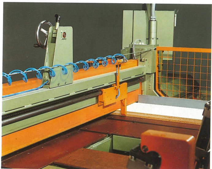
Bei der Queraufteilung eines oder mehrerer Längsstreifen ist die Winkel-Anpreß-Einrichtung WP 5003 von Bedeutung. Das Material wird dabei automatisch vor jedem Sägevorgang durch eine pneumatisch betätigte Anpreßklaue gegen den Winkelanschlag gedrückt und nach dem Sägevorgang zum Weitertransport wieder freigegeben. Diese Einrichtung ist an der Rückseite des Spannbalkens angebaut; entsprechend der Materialbreite wird die Anpreßklaue mit Handrad eingestellt (Verstellbereich 0 – 2400 mm).
