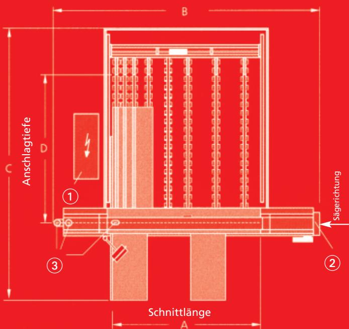
① Elektrischer Anschluß ② Luftanschluß ③ Absaugung
