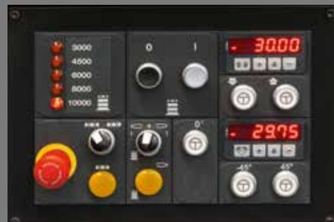
**Motorische Verstellung der Arbeitsaggregate mit Digitalanzeige**
