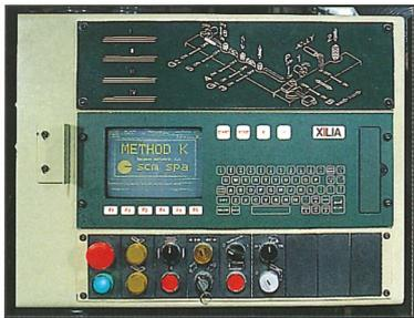
**CONTROL 20 PLUS** ist das Herz der **METHOD K**. Technisch auf dem neuesten Stand überwacht **CONTROL 20 PLUS** den gesamten Arbeitsablauf. Arbeitsaggregate, Anschläge, Werkstücklänge und alle anderen Funktionen werden von **CONTROL 20 PLUS** gesteuert und schnell und präzise fertigen zu Können. Am Bildschirm
