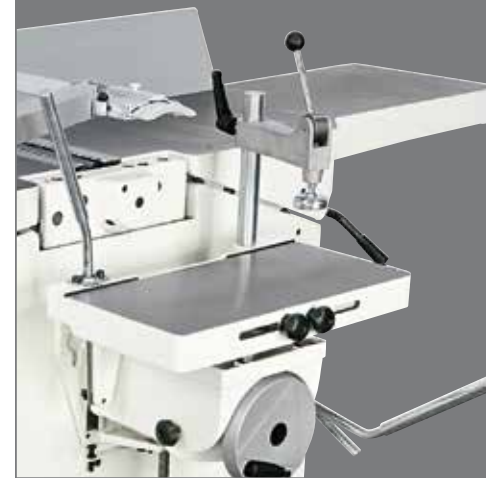
Guss-Langlochbohrereinrichtung Durch die Langlochbohrereinrichtung sind Nuten und Zapfen einfach ausführbar. Die Einrichtung ist komplett mit Absaughaube 120 mm Durchmesser und 16 mm Bohrfutter.
