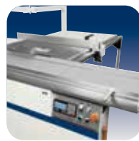
Programmierter Anschlag für Parallelschnitte
