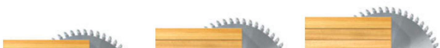
La sporgenza della lama principale e l'apertura del pressore sono regolate automaticamente da controllo numerico in funzione dello spessore del pacco da sezionare, ottenendo quindi la migliore qualità di taglio in ogni condizione di lavoro.
