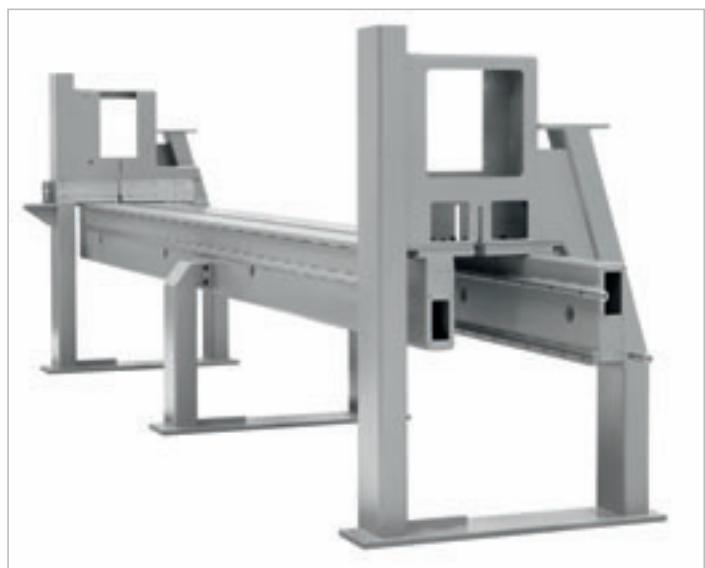
Il basamento della macchina è costituito da una solida struttura monolitica di acciaio, normalizzata e stabilizzata, sostenuta da robusti supporti che ne garantiscono la perfetta stabilità. Le guide di scorrimento del carro portalamere sono posizionate sulla stessa trave, assicurando quindi il perfetto parallelismo e rettilineità delle medesime.
