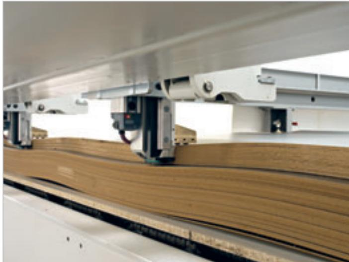
Sistema di chiusura della linea di taglio per evitare la caduta dei refili longitudinali.
