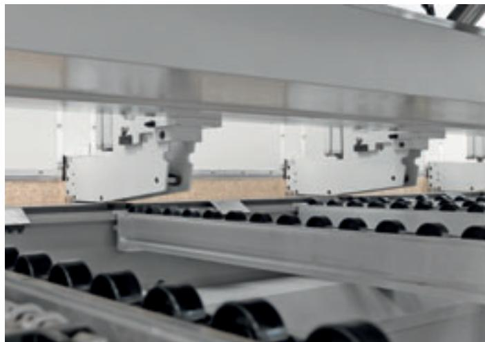
Il robusto carro spintore per il preciso e rapido posizionamento dei pannelli è azionato da un motore brushless. Il piano di scorrimento sotto lo spintore è correddato di rotelle folli ed indipendenti per evitare segnature su pannelli con superfici delicate.
