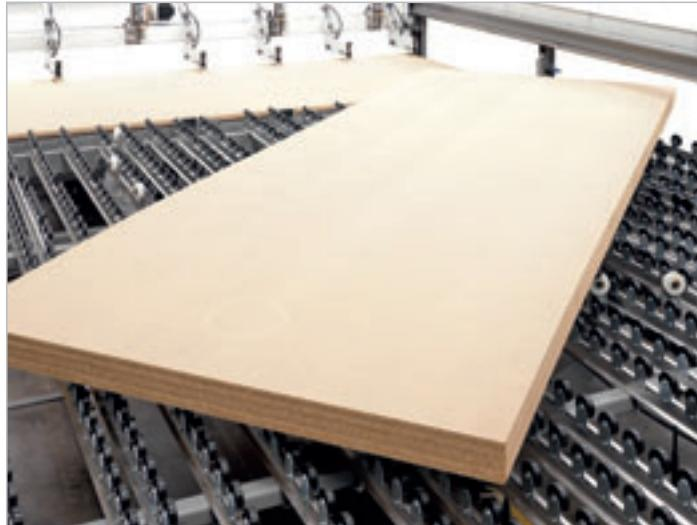
Stazione rotante (Brevetto Selco) in grado di ruotare il pacco di pannelli mantenendo l'allineamento al punto di riferimento prima e dopo la rotazione. Dispositivi di bloccaggio dei pannelli evitano la scomposizione del pacco durante la rotazione (opzionale).
