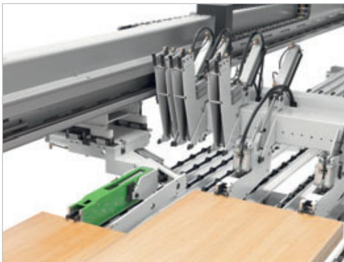
Spintore ausiliario composto da una pinza con posizionamento laterale a controllo numerico. La presenza di una battuta aggiuntiva consente la sezionatura indipendente di strisce larghe fino a 600 mm.
