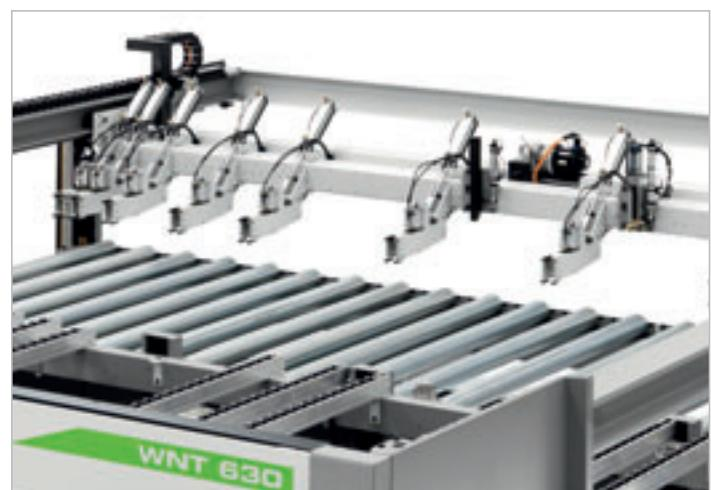
Le pinze, indipendenti ed autonivelanti, garantiscono un tenace bloccaggio del pacco dei pannelli. La loro particolare struttura e la logica della macchina consentono la completa espulsione dei pacchi di pannelli sezionati fuori dalla linea di taglio, agevolando in tal modo sia la loro movimentazione sia lo scarico dei refili.
