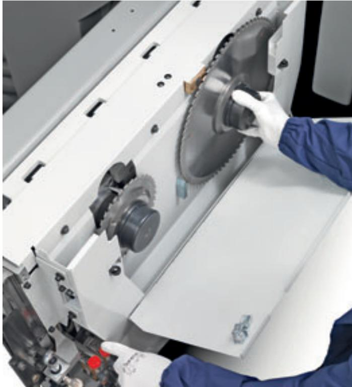
Sistema "Quick change" per lo sbloccaggio rapido delle lame senza utensili (brevettato).
