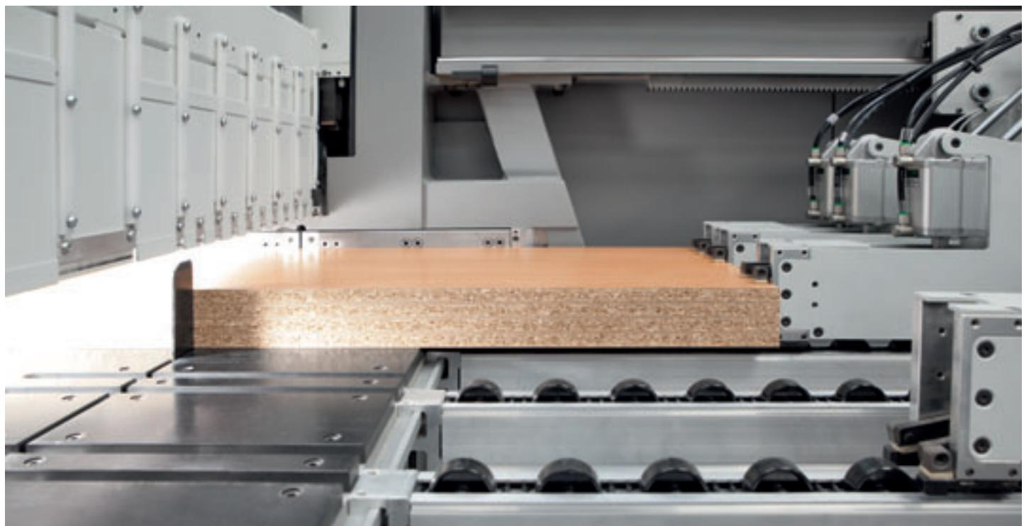
Battuta di allineamento laterale integrata nel carro lama. Le sue caratteristiche consentono di allineare perfettamente anche pannelli sottilissimi e/o flessibili riducendo al minimo il tempo di ciclo.
