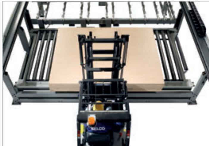
La tavola elevatrice è composta da un robusto telaio sollevato e mantenuto perfettamente planare da 4 grosse chiocciola di bronzo e da viti di acciaio azionate in sincronia tramite un motoriduttore. Il telaio è corredata di speciali alloggiamenti per permettere il carico diretto della pila.
