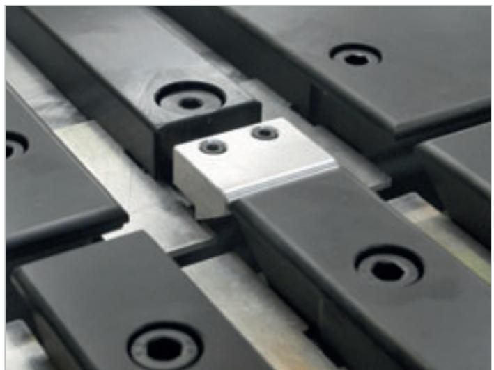
Piano corpo macchina a cuscino d'aria per la movimentazione di materiali delicati. Questa caratteristica permette inoltre di mantenere costantemente pulito il piano immediatamente a lato della lama.
