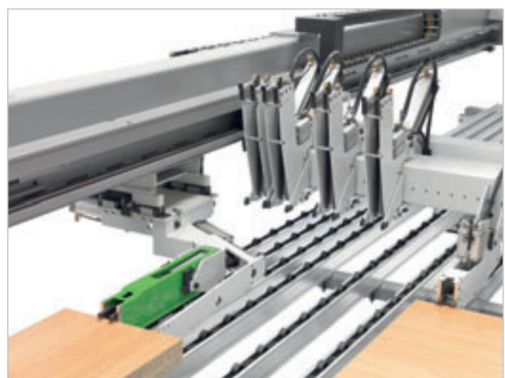
Sezionatura trasversale dell'ultima striscia con anticipo del carico e rotazione del pacco di pannelli successivo.
