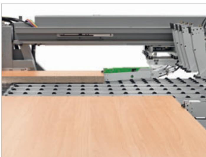
Sezionatura trasversale e longitudinale effettuata in un unico ciclo di lavoro.
