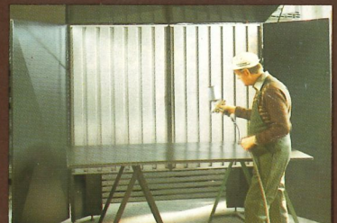
Trockenabsaugwand mit dreifach gestaffelten Prallblechen
