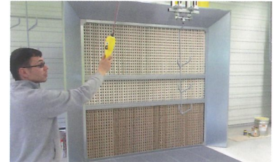
Absaugwand mit Unterflurabsaugung
