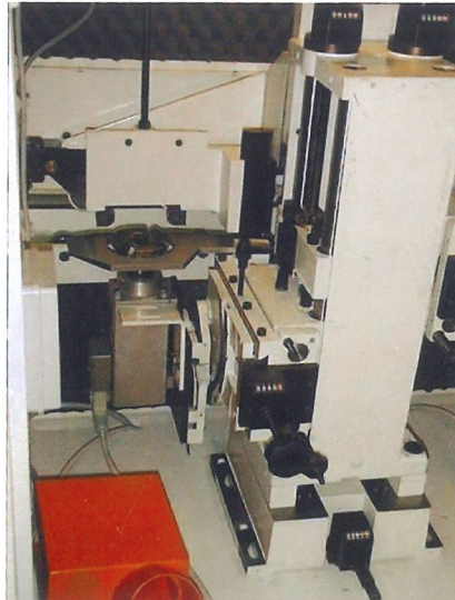
Gruppi rifilatori su spalla di contrasto per la pulizia del lato opposto del pannello
