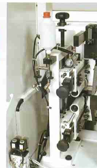
Gruppo cesoia longitudinale Longitudinal shear unit Grupo cizalla longitudinal
