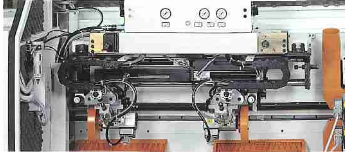
Gruppo intestatore End-trimming unit Grupo retesteador
