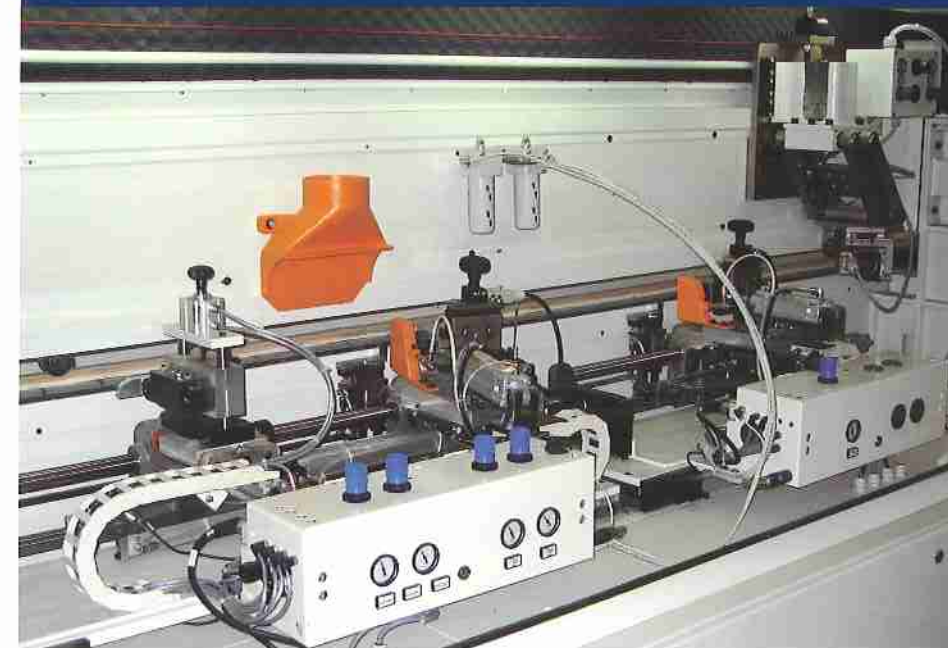
Gruppi di finitura degli angoli delle porte Door corner finishing units Grupos retoque de los ángulos de las portas
