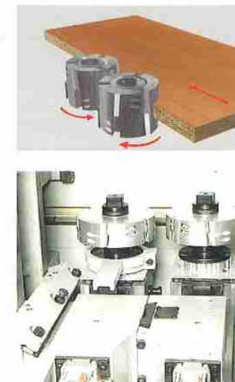
Gruppo rettificatore Pre-milling unit Grupo rectificador
