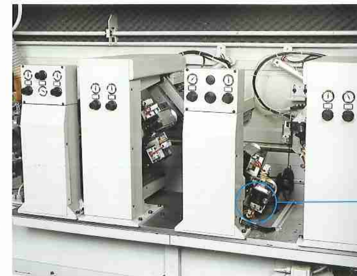
Gruppo arrotondatore 4 motori multifunzione Multifunctional 4 motors corner rounding unit Grupo redondeador 4 motores multifunción
