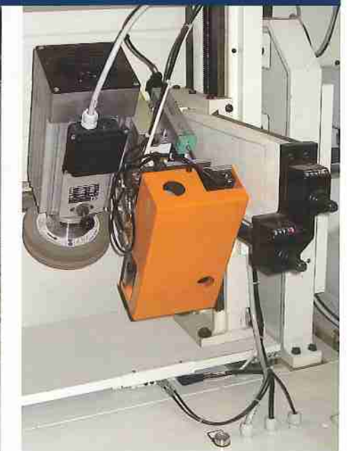
Gruppo levigatore a disco Disk sanding unit Grupo alisador de disco
