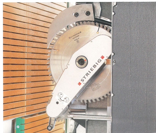
Inciseur VSA, couteau diviseur avec remise hors fonction automatique, capot d'aspiration à fermeture rapide
