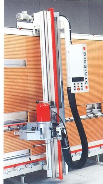
AUTOMAT TRK – Arbeiterleichterung und Zeitgewinn beim Horizontal- und beim Vertikalschnitt.
