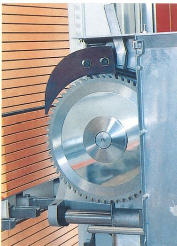
Der Spaltkeil gleitet nach jeder Bedienung in die Ausgangslage zurück.
