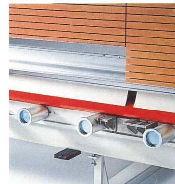
Die kugelgelagerten, gebremsten Auflagerollen sind im Hauptsägebereich besonders dicht angeordnet.
