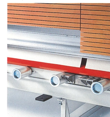
Les rouleaux d'appui montés sur roulements à billes, placés en grand nombre dans la zone de coupe principale.
