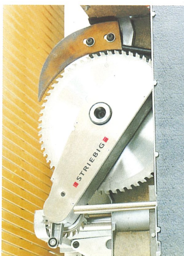
Der Spaltkeil gleitet nach jeder Bedienung in die Ausgangslage zurück. Abb. mit Vorritz-Sägeaggregat (Option).
