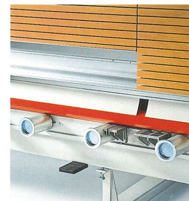
Die kugellagerten, gebremsten Auflagerollen sind im Hauptsägebereich besonders dicht angeordnet.
