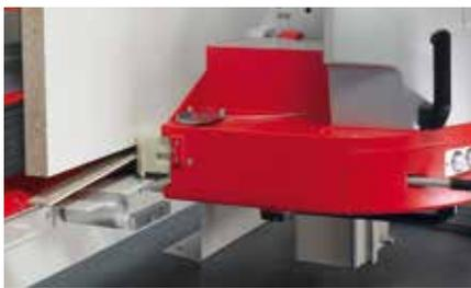
Platten bis zu 5300mm Länge und einer Höhe von 2185mm werden mit dem 4SB-System automatisch unten besäumt. Schwere körperliche Arbeit entfällt.
