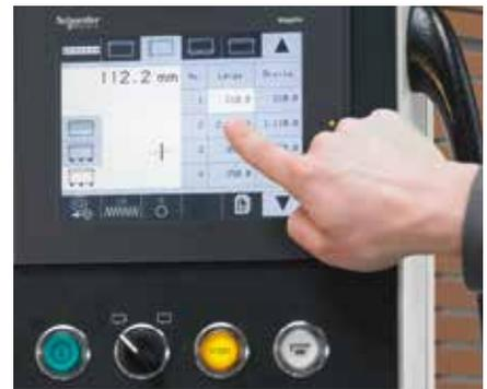
Masse eintippen, fertig. Das Elektronische-Positioniersystem EPS ist vollständig in das Touch-Screen Panel integriert. Es erlaubt die einfache und auf den 1/10mm genaue Positionierung der horizontalen und der vertikalen Schnittachse.
