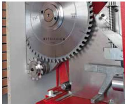
Zeit-, kosten- und werkzeugsparend – die Vorteile des Vorritzsägeaggregates VSA. Bei größeren Mengen und einem evtl. niedrigen Qualitätsniveau der Platten ist das VSA ein „Muss“. Denn: Die Standzeit eines Hauptsägeblattes verlängert sich um das 7-8fache. Ein Vorritz-Sägeblatt übersteht mind. 3 Hauptsägeblätter.
