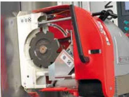
Bei vielen Aufträgen sind Nut- oder Fräsarbeiten notwendig. Diese können auf einer CONTROL ohne Probleme ausgeführt werden. Sie können Holzwerkstoffe und Verbundplatten fräsen und nuten.
