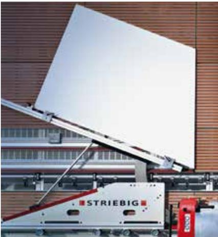
Das Winkelschnittgerät WSG kann links und rechts neben jeder vertikalen Schnittstelle eingesetzt werden. Es ist einfach und schnell montiert. Einsatzbereich: Platten bis 42mm Stärke, exakte Winkel und Gehrungen von 0° - 46°.
