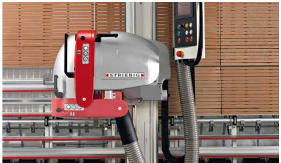
Die automatische Motorschwenkung ist nur eine der zahlreichen Funktionen, die das vollautomatische Sägen der CONTROL unterstützen.
