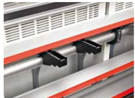
„High-End“-Raster aus faserverstärktem Kunststoff-Material bieten bei besonders empfindlichen Kantenmaterialien und Postforming-Kanten speziellen Schutz.
