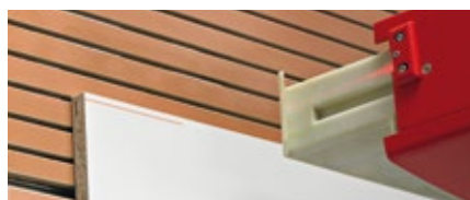
Affichage de la coupe horizontale, assisté par laser (de série).
