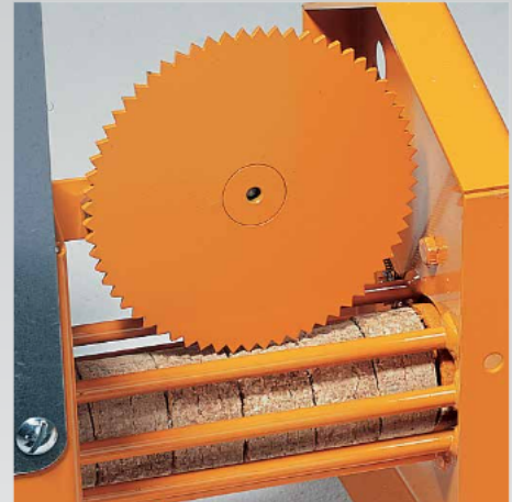
Elektronische Längenüberwachung der Presslinge über laufradgesteuerten Impulsgeber in Kombination mit Pressenabschaltung bei Materialende.
