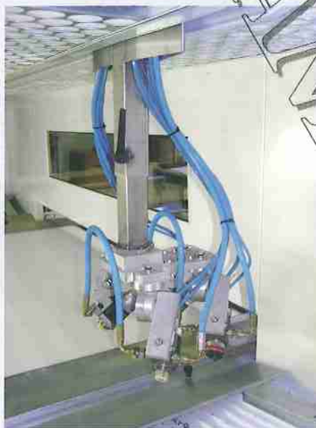
Braccio di spruzzatura_ Spraying arm_ Spritzarm_ Bras de pulvérisation_ Brazo reciprocador barnizado
