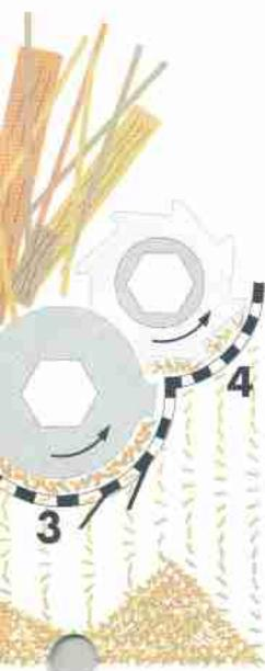
Das Ergebnis ist ein feines, homogenes Endgranulat. Bei der Zerkleinerung von Holz verhindern Spänebrecher den Durchgang von langen Spänen.
