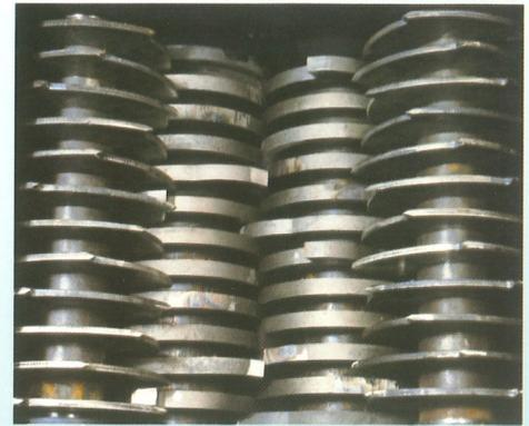
Schneidwerk mit Spezialstahl und patentierten Räum- und Einzugscheiben.
