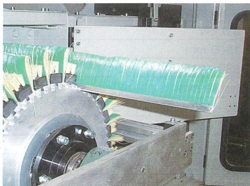
Abb.: Wechseln des Bürstenbesatzes
