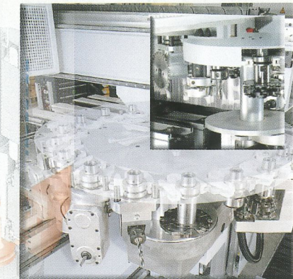
Mitfahrender 8fach oder 18fach Werkzeugwechsler in X-Richtung
