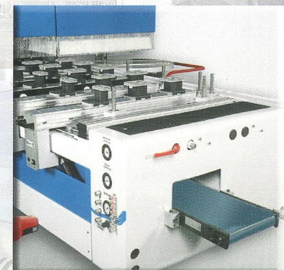
Ein Spänentransportband kann optional im stabilen Maschinenrahmen integriert werden
