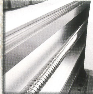
Langlebiges geschlossenes Linearführungssystem
