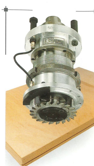
HSK 63 Fräsen vertikal mit getasteter Kufe Für Fräsbearbeitung in der Werkstückoberfläche, an Profilen oder für Formfeder-Verbindungen, mit C-Achsen gesteuert. Anfallende Späne werden über die integrierte Luftdüse entfernt (0°-360°).
