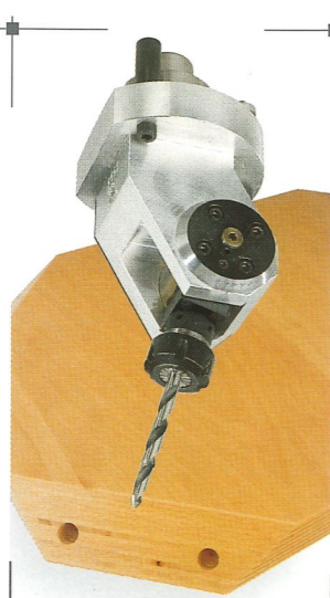
HSK 63 Bohren/Fräsen neigbar Für Bohr- und Fräsarbeiten bis zu einer Tiefe von 78 mm (0°-360°). Die Neigung des Werkzeugs kann manuell eingestellt werden (0°-90°).
