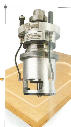
HSK 63 Fräsen vertikal mit getasteter Glocke Für Fräsbearbeitung in der Werkstückoberfläche, an Profilen oder für Formfeder-Verbindungen. Die Tastglocke kann ganzflächig auf dem Werkstück aufliegen. Anfallende Späne werden über die integrierte Luftdüse entfernt.
