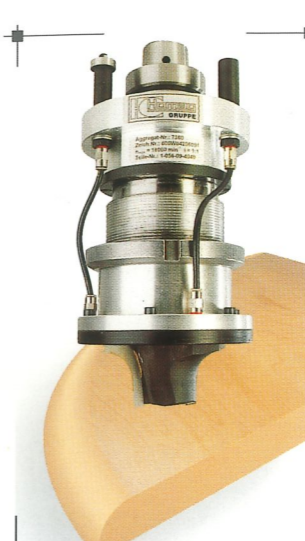
HSK 63 Fräsen vertikal mit getasteter Glocke Für Fräsbearbeitung in der Werkstückoberfläche, an Profilen oder für Formfeder-Verbindungen. Die Tastglocke kann ganzflächig auf dem Werkstück aufliegen. Anfallende Späne werden über die integrierte Luftdüse entfernt (0°-360°).
