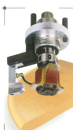
HSK 63 Adapteraufnahme für Schleifkörper Für Schleifarbeiten an MDF- oder Massivholzkanten. Der Schleifkörper wird über eine Luftdüse kontinuierlich mit Druckluft gereinigt.
